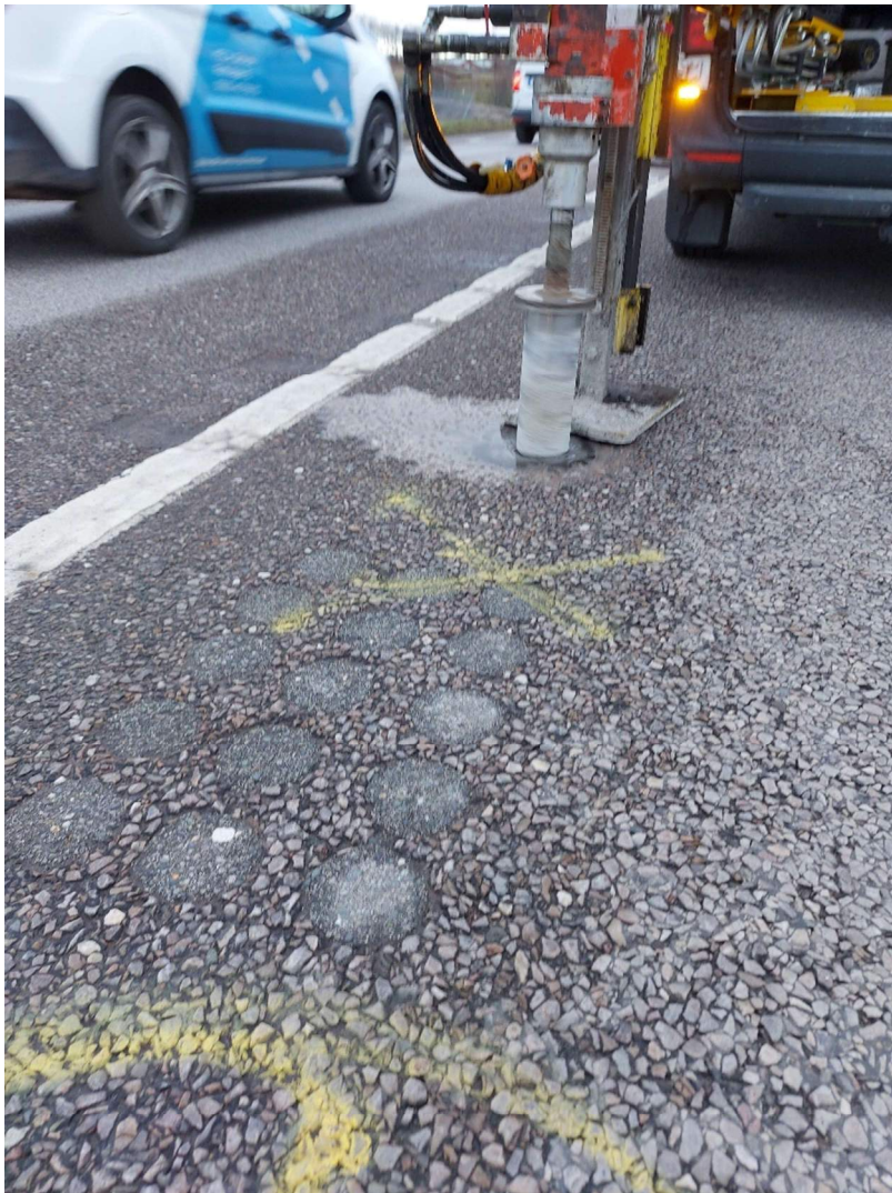
Figur 1 Ursprunglig positionering av nya prover i direkt anslutning till de som togs 2016
