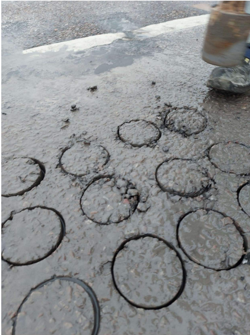
Figur 2 Prover efter borrning, flera visar på skador redan här och de flesta kunde inte plockas upp ur belägningen i ett stycke
