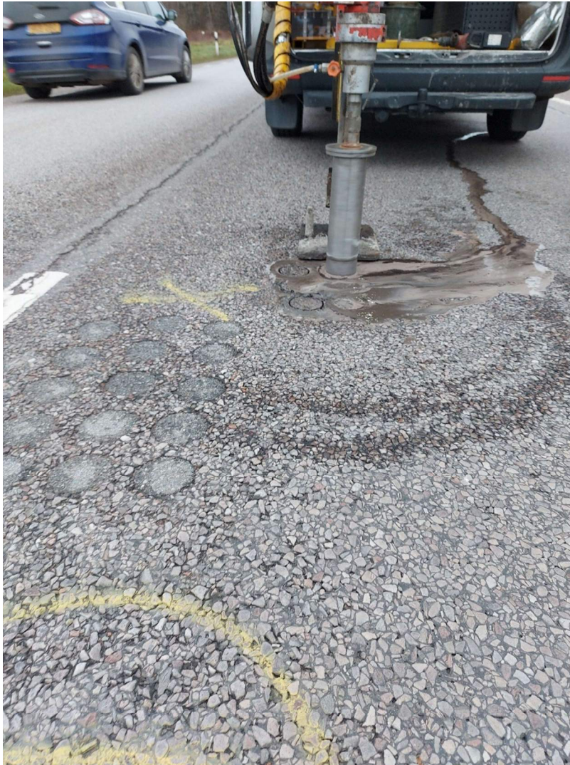
Figur 3 Provtagningsplatserna förflyttades i sidled på det sättet som visas på denna bild för att möjliggöra provtagning
