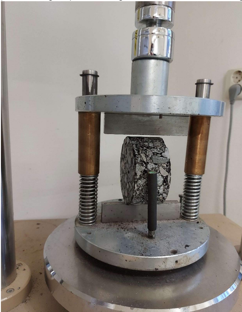
Figur 7 En provkropp som förbereds för att pressas
